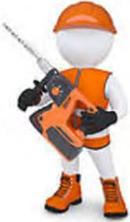
Com aparência similar à da furadeira, o martetele é um tipo de britadeira que pode ser utilizado em obras de diferentes tamanhos na construção civil. Também conhecido como martelo de demolição, é ideal para perfurar e romper concreto e cerâmica. Disponível em dois modelos – perfurador e rompedor, o equipamento é uma opção viável para reformas, manutenções e reparos.
